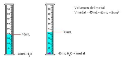
Figura 2. Procedimiento para la determinación de la densidad de un sólido irregular
